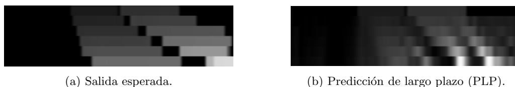
Figura 5.5: Comparación entre el VMD real y la predicción de largo plazo (PLP) del VMD* en un horizonte de 5 instantes. Figura (a) La evolución del VMD real cada vez que el robot se mueve hacia adelante comenzando con el vector de la parte superior de la imagen. Figura (b) La predicción para el VMD* para cada uno de los 5 instantes.
