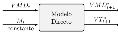
Figura 5.4: Modelo directo implementado. Se muestran la información de entrada y las predicciones de salida. Al tiempo t la entrada sensorial visual junto con el comando motriz permiten realizar una predicción sensorial de las modalidades visuales y táctiles al tiempo t + 1 .
