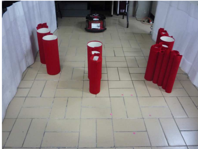
Figura 7.3: Ambiente para el experimento de adquisición del concepto de pasabilidad . El agente se encuentra situado frente a una escena visual que muestra dos aperturas, según la imagen, por la de la izquierda el agente no puede pasar mientras que por la de la derecha si.
