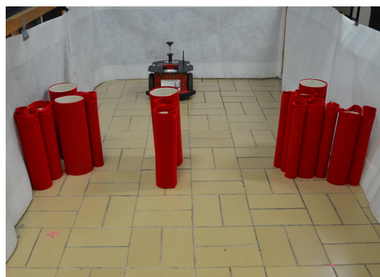
Figura 7.9: Segundo ambiente para el la prueba del concepto de pasabilidad realizando una corrección en su trayectoria. El agente puede pasar por la apertura de su lado izquierdo mientras que no por la de su lado derecho.
