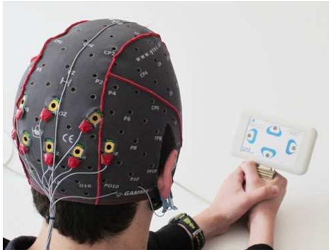
*Figura 3.5: Control SSVEP con 4 frecuencias distintas de parpadeo de leds (Guger et al., 2012).*
